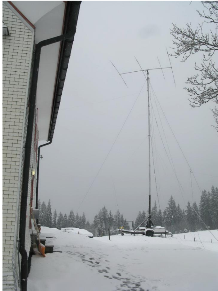
Der eingefrorene Pneumatikmast auf dem Anhänger
